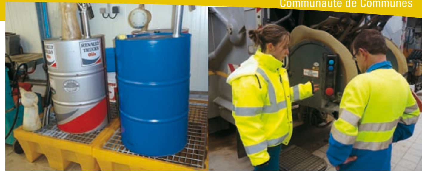
Rétention sous les bidons d'huile moteur dans l'atelier.
